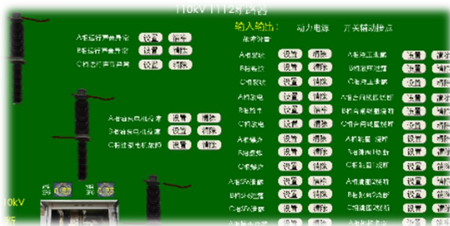
图 5-30 宗永线断路器各种故障和不正常工作状态设置
