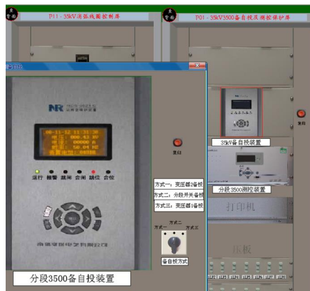
图 5-12 35kV 备自投（3500）仿真方式
