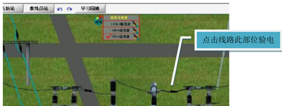
图 5-19 35kV 间隔验电部位
