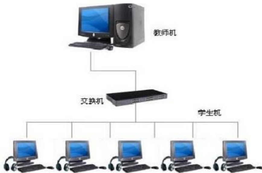
图 1 仿真系统局域网连接示意图
