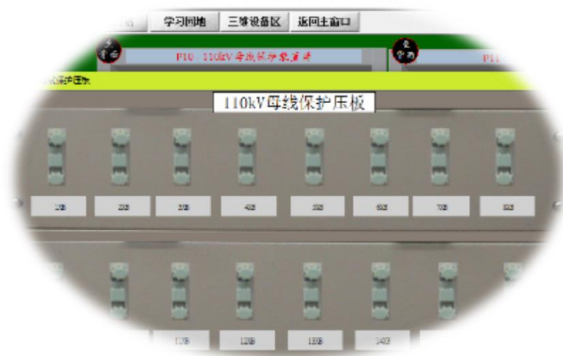
图 6-7 110kV 母差保护压板
