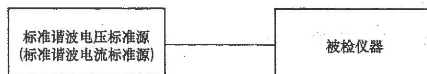
图5 标准源法谐波电压、谐波电流检定示意图
